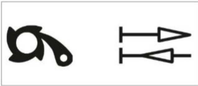
Symbole für Rücklaufschutz und Zählrichtung auf dem Stromzähler
